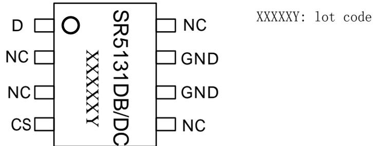
图 2 SR5131D 管脚封装图
