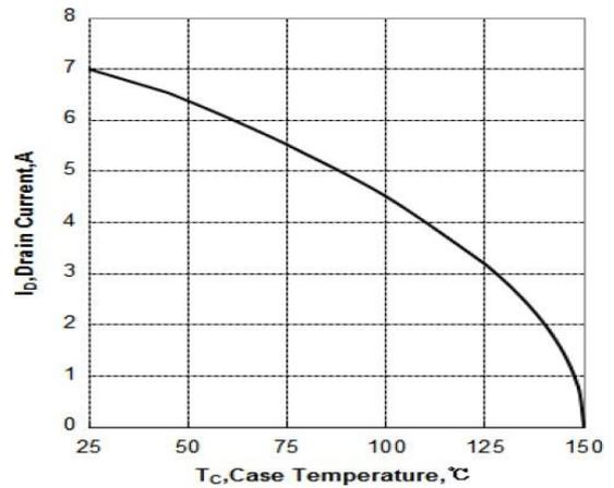
图5 最大漏极电流与壳温曲线
