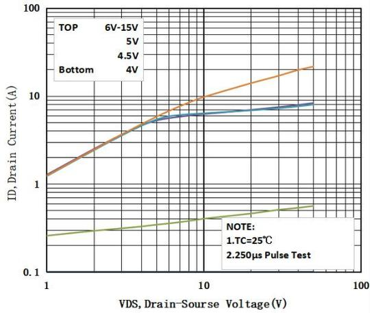
图2 输出特性曲线,  $T_c=150^\circ\text{C}$
